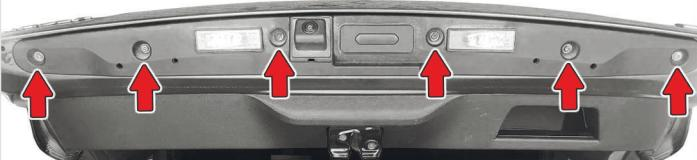
**2** Отсоедините **разъемы подсветки номера, кнопки открывания багажника и камеры заднего вида** и снимите **торцевую накладку** крышки багажника.
