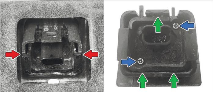
**4** Прикрутите камеру ко внутренней части нового кронштейна с помощью **штатных саморезов**. Установите наружную часть кронштейна с омывателем в накладку крышки багажника, вставьте изнутри камеру с частью кронштейна. Закрутите **2 самореза** из комплекта.
